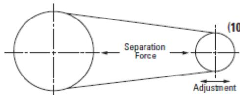
**Fig. 21 Shaft Separation Method**
