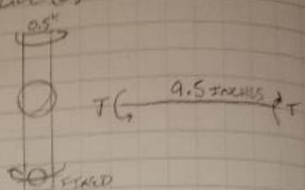
FIND: Torque + ANGLE OF TWIST
